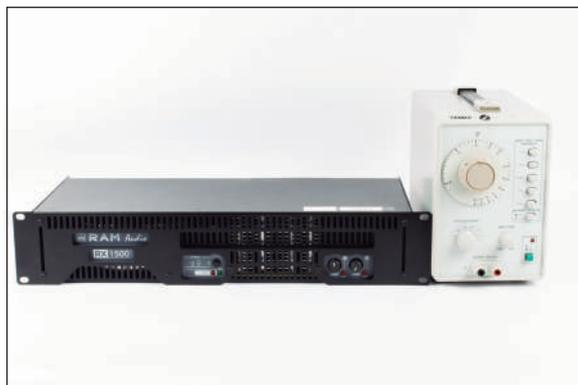
Verificar el correcto funcionamiento del motor de compresión ( $8 \Omega$ ) aplicando una señal de 3.5 V de amplitud y hacer un barrido de frecuencia empezando en una frecuencia no inferior a 200 Hz.
