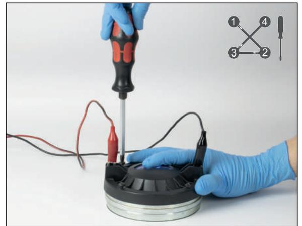
Colocar el conjunto móvil junto con los tornillos necesarios. Aplicar una señal senoidal de 200 Hz y 3.5 V de amplitud. Sujetar el conjunto móvil de forma que no distorsione y apretar los tornillos progresivamente en el orden indicado.
